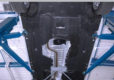
POWER LIFT HL 2.30 NT DT – короткая трехсекционная телескопическая лапа обеспечивает большее удобство при подъеме короткобазных широких автомобилей
