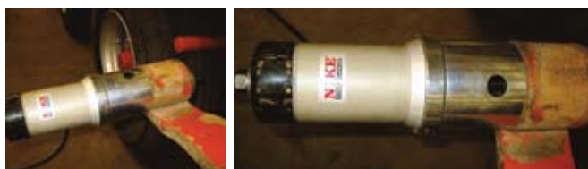
Удаление сайлентблока с использованием гидравлического выпрессовщика на 18 тонн..
